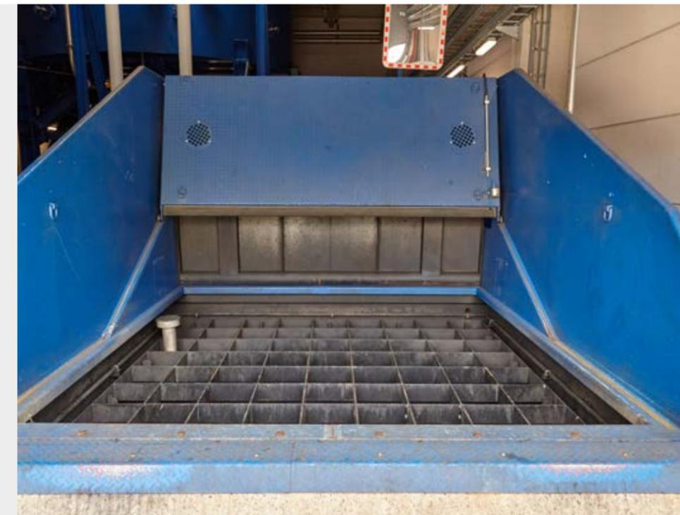
**Oben:** Annahnebunker mit Rechteckgleitrahmen und Pumpenbeschickung. Automatische gesteuerte Klappen sind gerade bei Annahnebunkern wichtig. Putzmeister bietet unterschiedliche Varianten.
