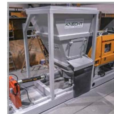
L'accumulatore tampone si può collocare direttamente nell'impianto di miscelazione, oppure lo si può rifornire tramite una preesistente pista a casse.
